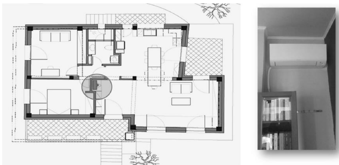
Slika 35. Lokacija klimatskog uređaja na tlocrtu [27]
