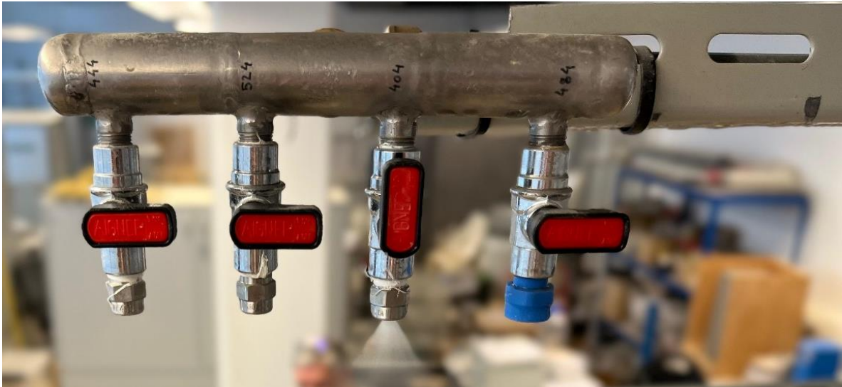
Slika 18: Mlaznice na simulatoru kiše
