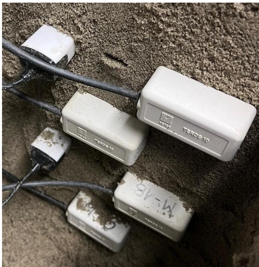
Slika 17: Ugrađeni senzori u gornjoj (H) zoni
