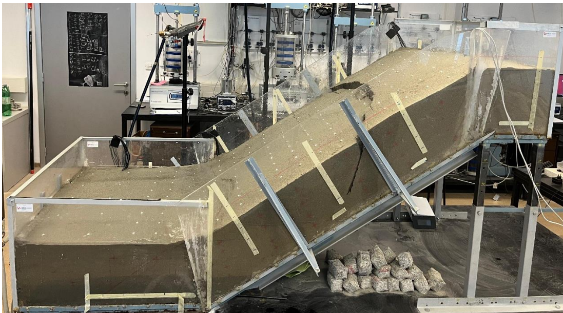
Slika 32: Bočni prikaz sloma kosine
