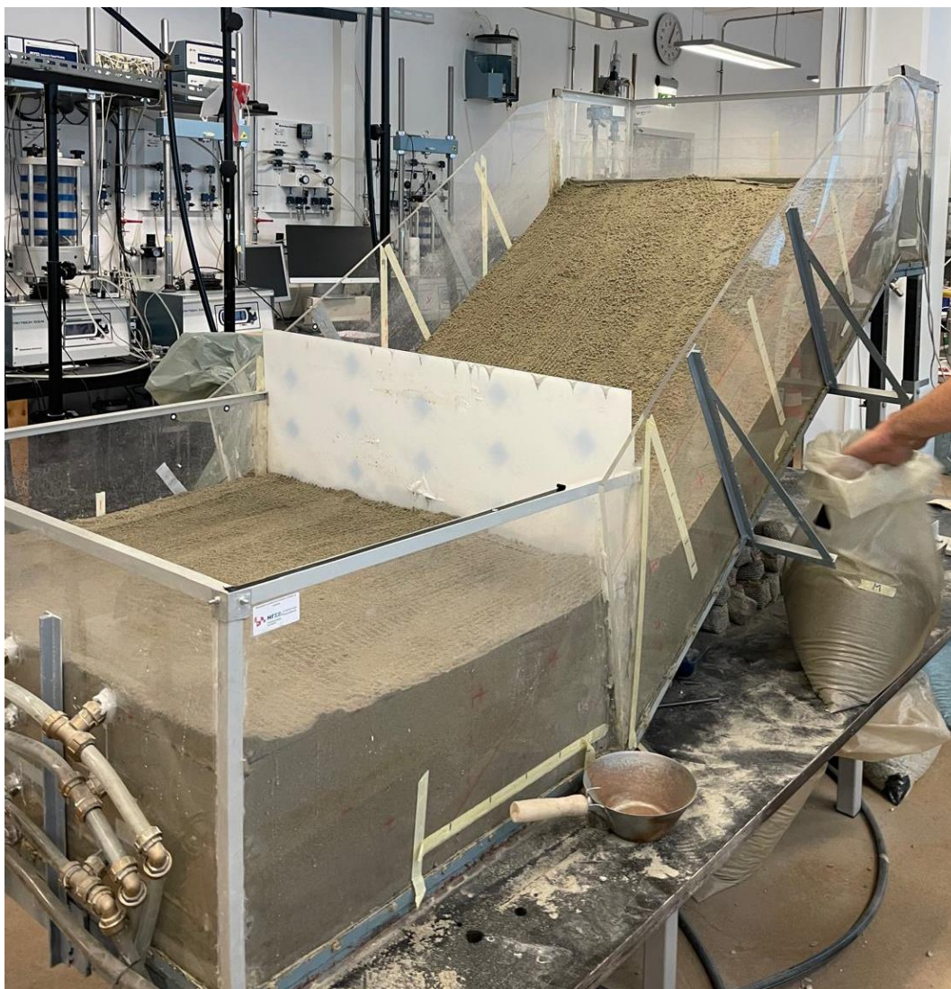
Slika 16. Model kosine s prikazanim donjim dijelom modela sa u potpunosti ugrađen materijalom i središnji dio u kojem je materijal djelomično ugrađen
