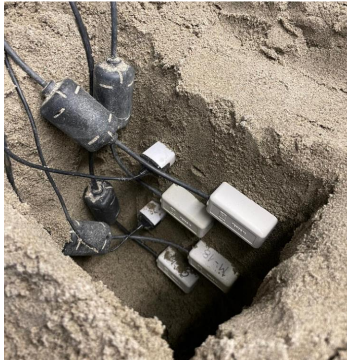
Slika 17. Prikaz senzora teros 10 (desni stupac, 4 komada) i teros 31 (lijevi stupac, 2 komada)
