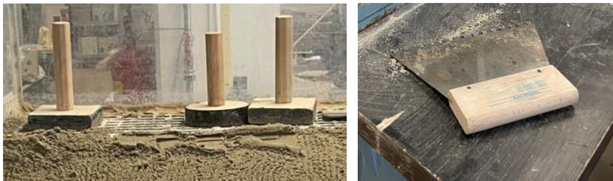
Slika 15. Alat koji se koristi tijekom ugradnje materijala: nabijači (lijevo) i nazubljena špahtla (desno)
