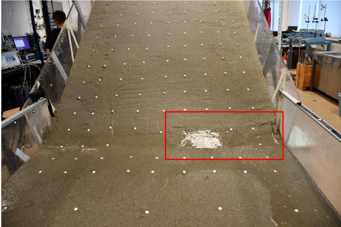
Slika 27. Prva pukotina pojavila se nakon 59 minuta od početka pokusa
