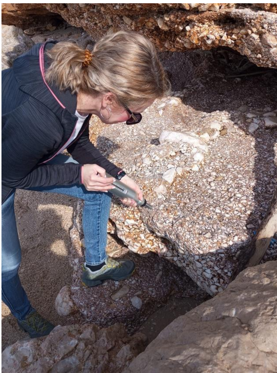
Slika 14: Ispitivanje stijenske mase Shmitovim čekićem, Lokacija 1, manje trošna stijena
