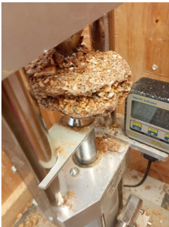
Slika 33: Probijanje uzorka, primjer odbačenog pokusa
