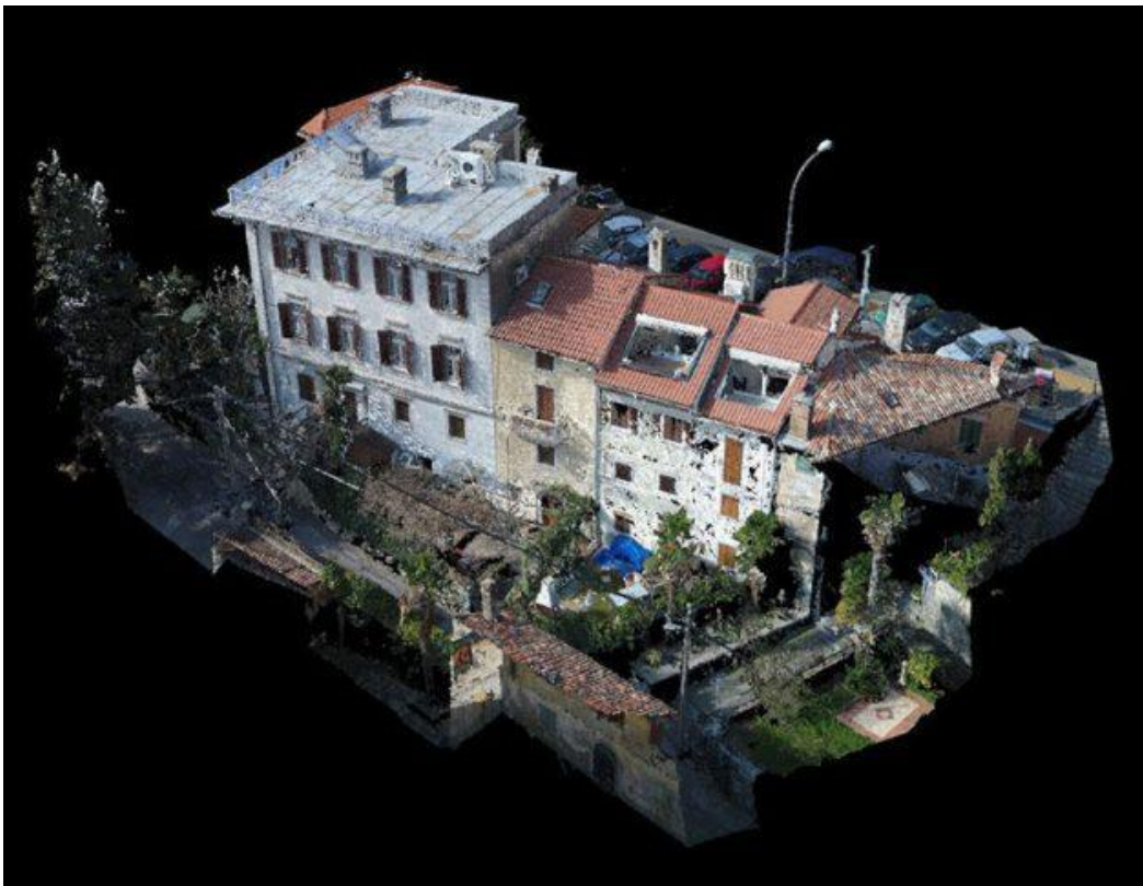
Slika 13 : Objekt prikazan u tri dimenzije snimljen metodom terestričke fotogrametrije
