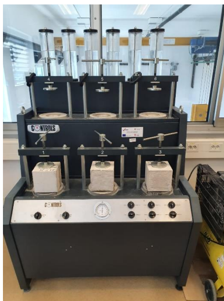
Slika 32: Stroj za utiskivanje vode pod tlakom [foto autor]
