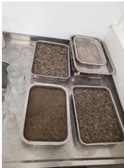
Slika 9: Potopljene frakcije agregata u vodi [foto autor]
