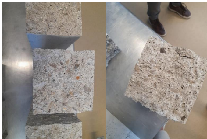
Slika 20: Pore i šupljine u mješavini REF (lijevo) i REF + 10M + 15%PVC (desno) [foto autor]
