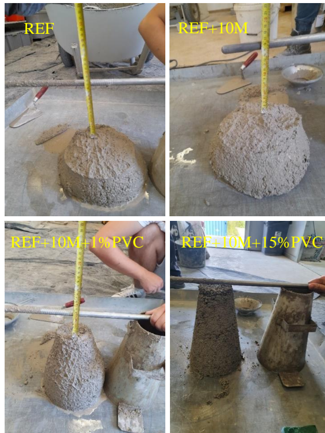
Slika 19: Ispitivanje konzistencije svježih betonskih mješavina metodom slijeganja [foto autor]
