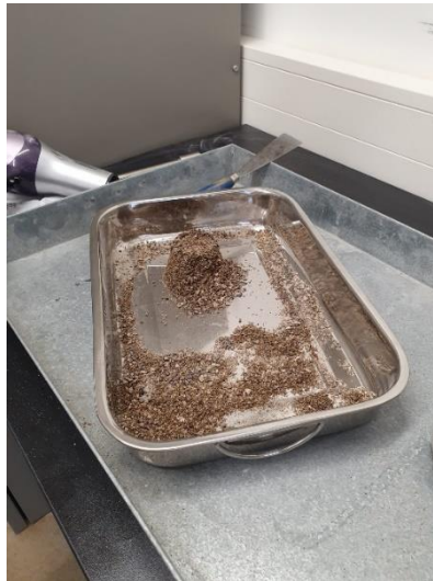
Slika 11: Zasićen površinski suh pijesak [foto autor]
