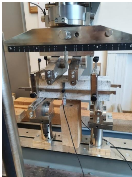
Slika 25: Preša za ispitivanje vlačne čvrstoće na savijanje sa dvije koncentrirane sile [foto autor]
