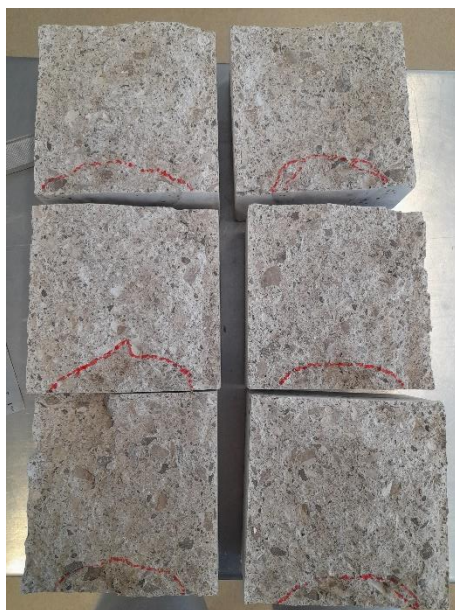
Slika 33: Dubina prodiranja vode u mješavinu REF+10M [foto autor]
