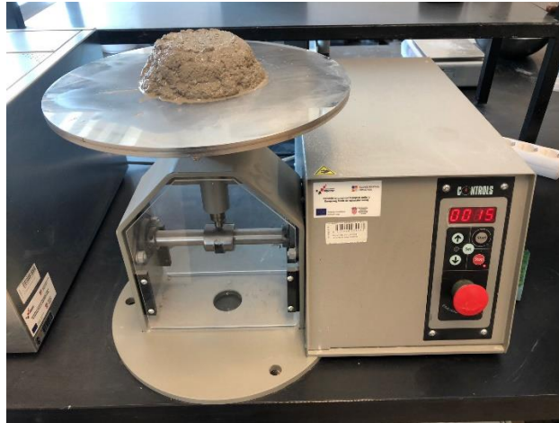
Slika 21. Potresni stolić za ispitivanje konzistencije rasprostiranjem
