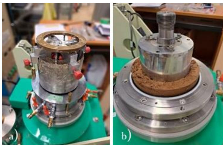
Slika 18. Ugrađivanje neporemećenog uzorka u posmičnu ćeliju: a) tijekom procesa istiskivanja b) na početku ispitivanja [9]
