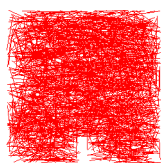
(a) V_f=0.5\% , pogled cijele grede
