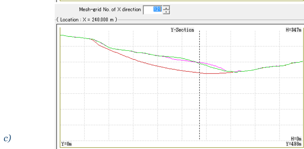
Slika 5.18 Rezultati numeričkog modela klizišta Valići u dolini Rječine u flišnoj stijenskoj masi II/I (SW/FR) stupnja trošnosti: a) 3D model površine terena klizne mase i položaj uzdužnog i poprečnog presjeka, b) uzdužni i c) poprečni presjek kroz kliznu masu na kraju klizanja, pri r_u=0,6
