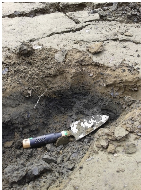
Slika 4.6 Uzorkovanje istaloženih naslaga podrijetlom iz fliša različitih stupnjeva trošnosti s dna akumulacije Valići u dolini Rječine
