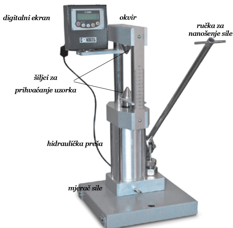
Slika 4.15 Uređaj za ispitivanje čvrstoće u točki PLT metodom
