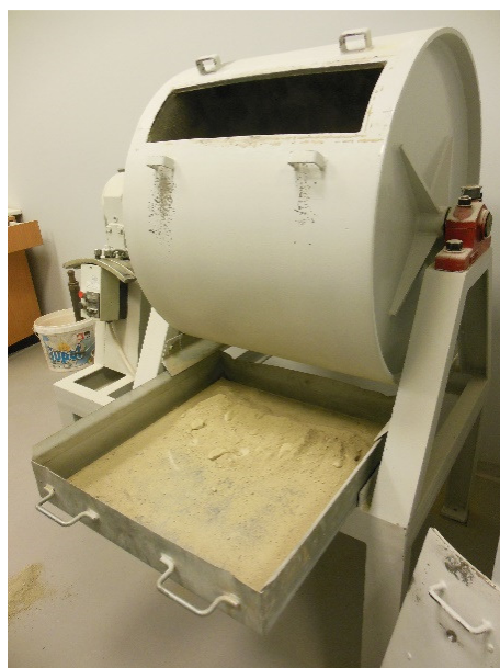
Slika 4.9 Usitnjavanje uzoraka metodom Los Angeles
