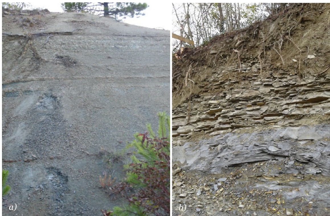
Slika 4.5 Uzorkovanje sitnozrnastih litoloških članova fliša različitih stupnjeva trošnosti u Istri: a) na izdanku flišne stijenske mase blizu sela Cunj, b) na pokosu izgrađenom u flišnoj stijenskoj masu blizu sela Sovinjak
