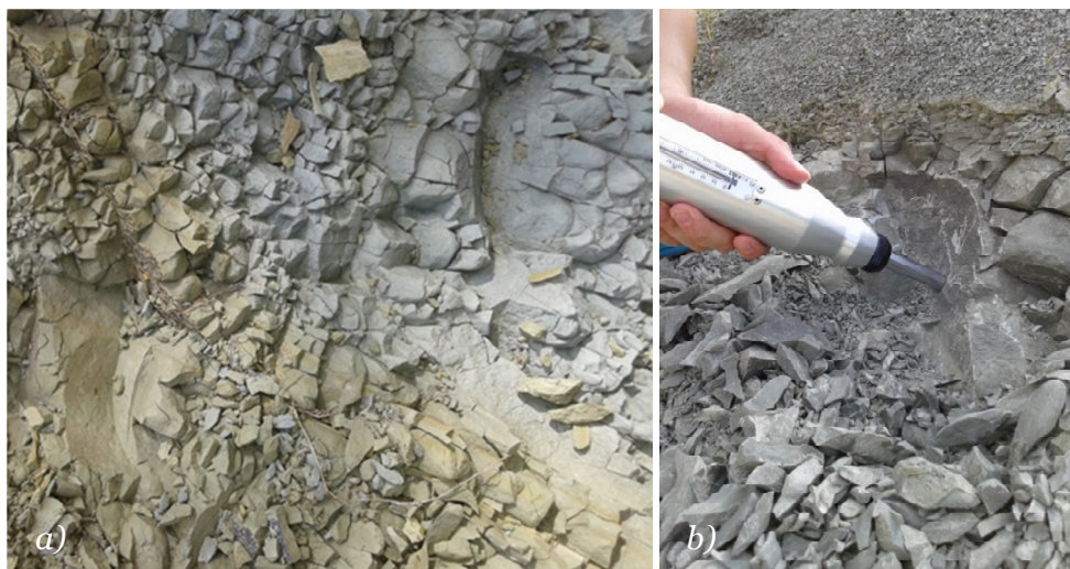
Slika 4.2 Određivanje stupnjeva trošnosti na osnovi: a) promjene boje i b) jednoosne tlačne čvrstoće dobivene iz pokusa Schmidtovim čekićem
