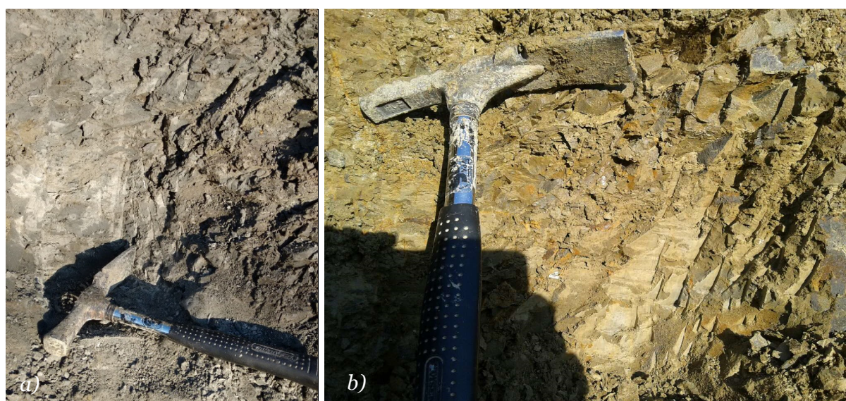
Slika 4.8 Uzorkovanje sitnozrnastih litoloških članova: a) II/I (SW/FR), b) IV/V (HW/CW) stupnja trošnosti na izdanku flišne stijenske mase u Vinodolskoj dolini
