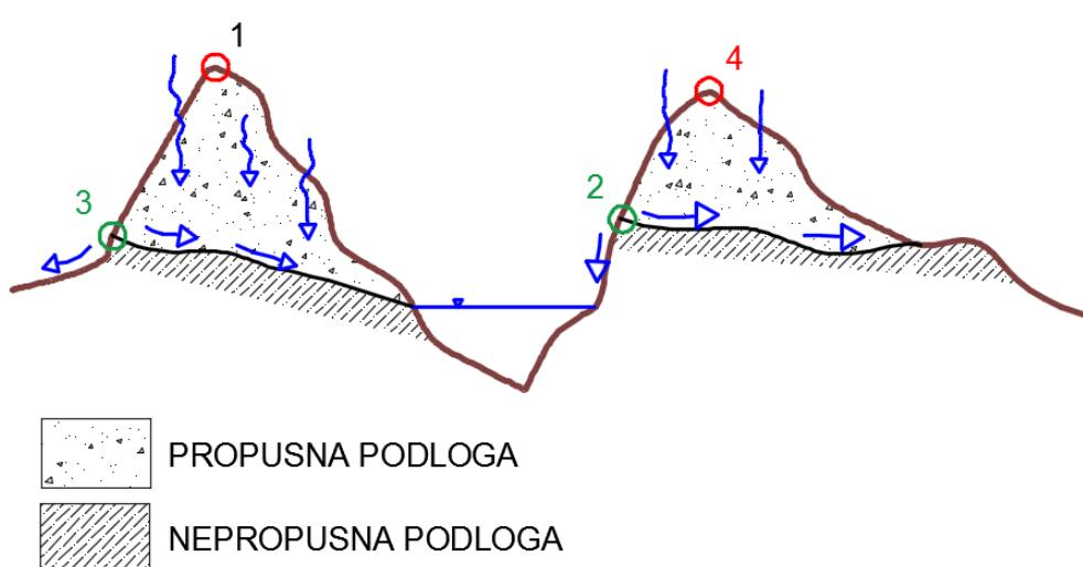
Slika 7. Shematski prikaz razlike topografskog i utjecajnog sliva tlocrtno i presjekom A---A; prikaz izradila: Ivana Sušanj prema Žugaj (2000)
