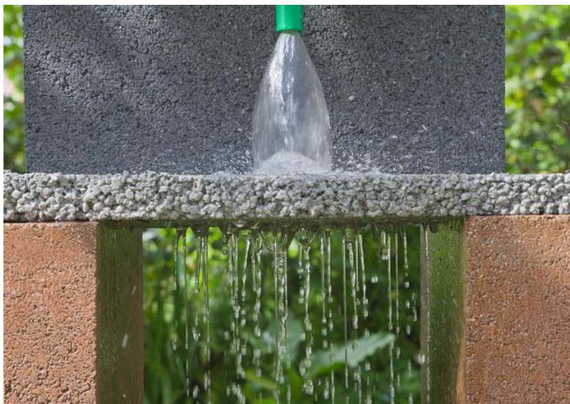
Slika 6: Beton od jednozrnatog agregata [17]
