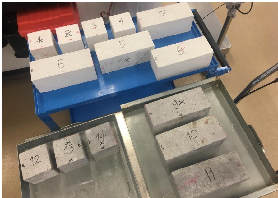
Slika 20: Uzorci betona (1-7 uzorci porobetona, 9-12 uzorci betona armiranog vlaknima)
