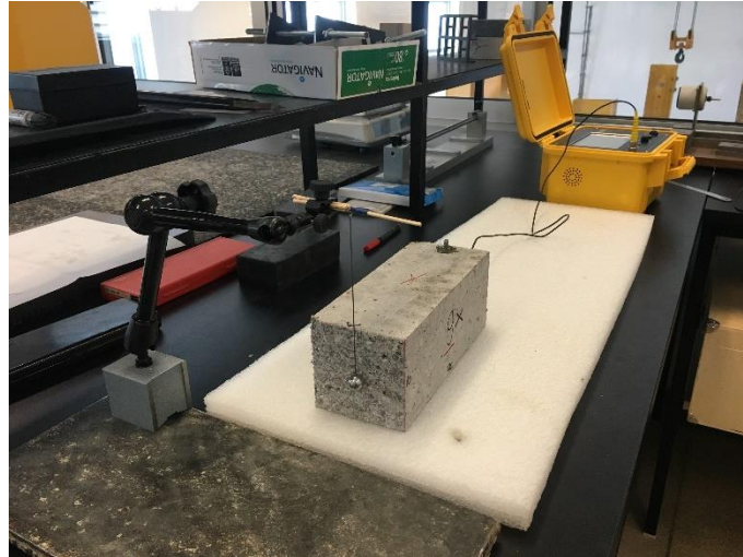
Slika 27: Uređaj za mjerenje rezonantne frekvencije i uzorak postavljen na spužvastu podlogu
