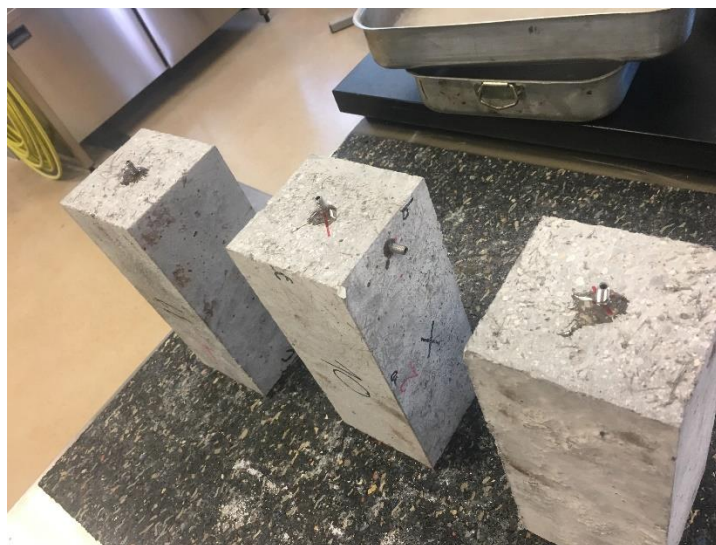
Slika 24: Postavljeni navoji na prizmatične uzorke (priprema za ispitivanje dinamičkog modula elastičnosti)
