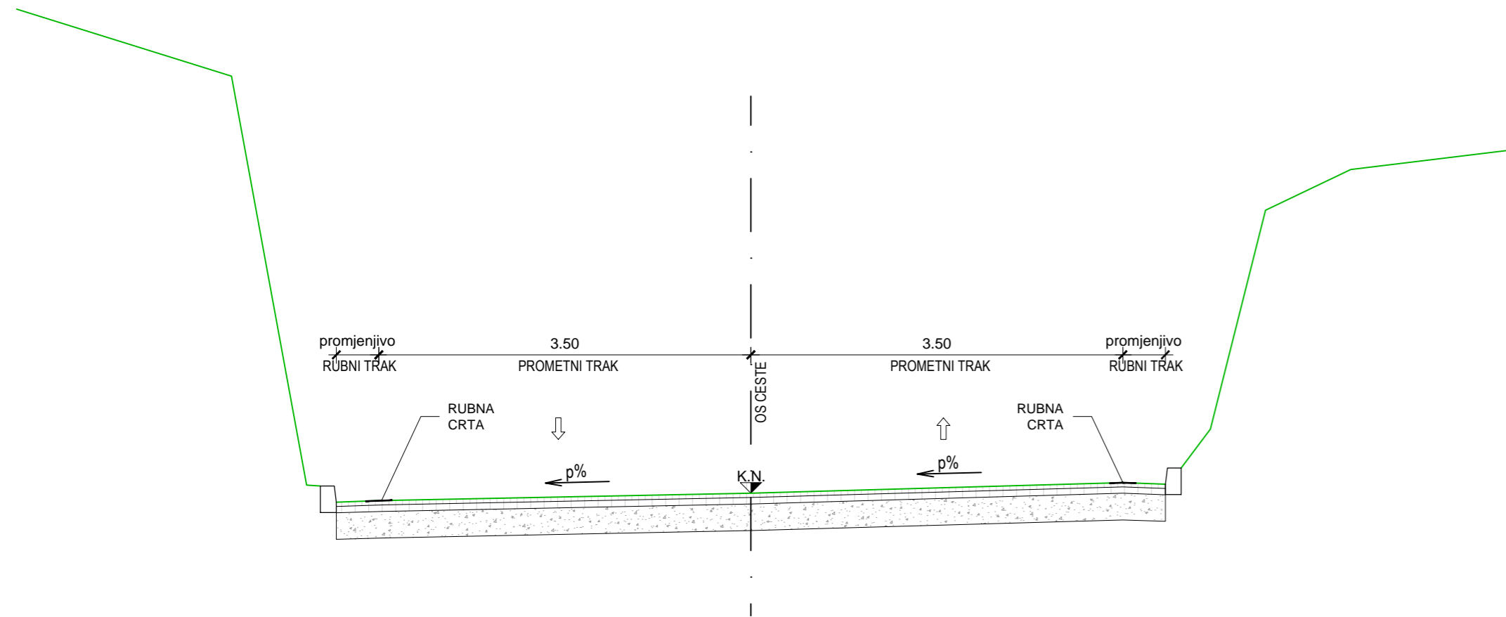
KARAKTERISTIČNI POPREČNI PRESJEK CESTE POSTOJEĆEG STANJA NA DIJELU USJEKA
