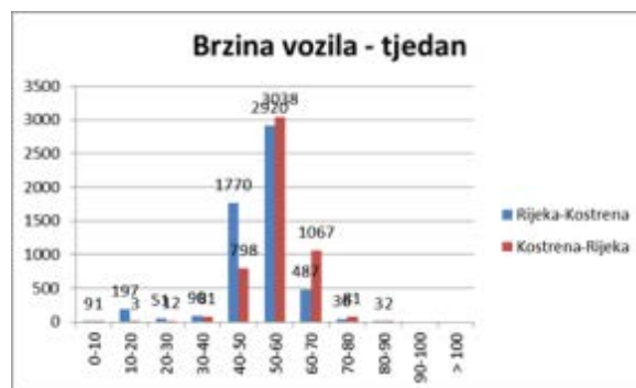
Slika 13. Broj vozila u odnosu na brzinu
