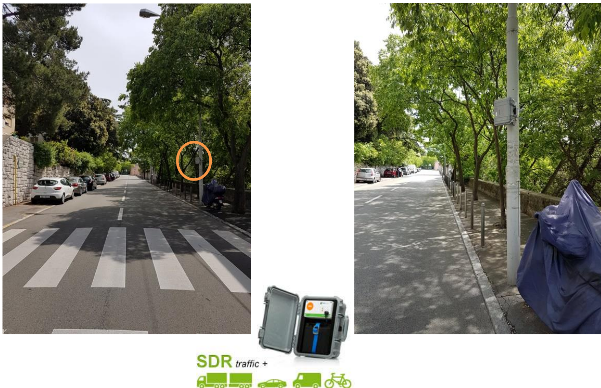
Slika 13: Primjer postavljenog brojača prometa SDR traffic+ u naselju Pećine [7]
