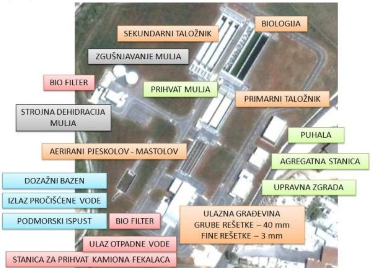
Slika 9: Shema uređaja Centar [1]
