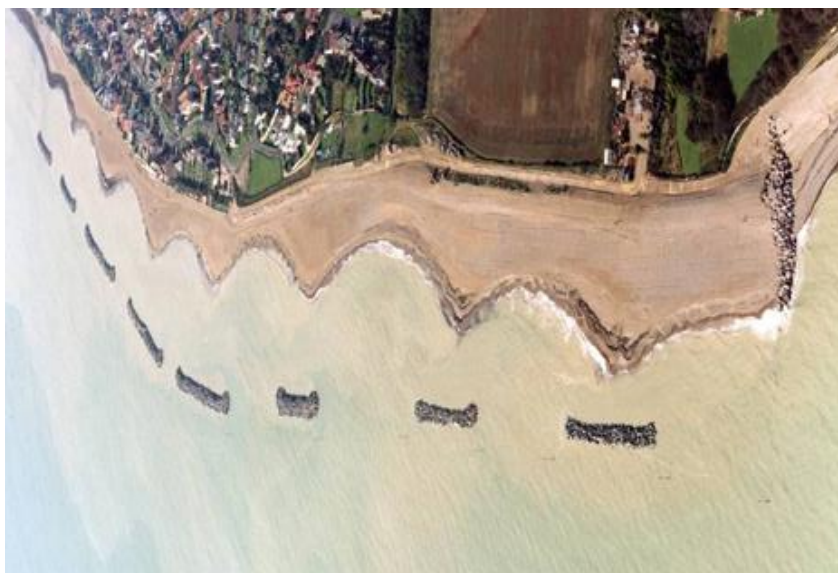
Slika 1: Odvojeni višestruki lukobran, UK [8]
