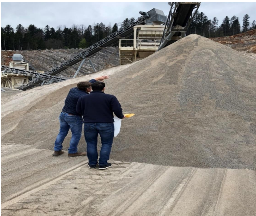
Slika 17: Uzimanje uzoraka frakcije 0 - 4 mm
