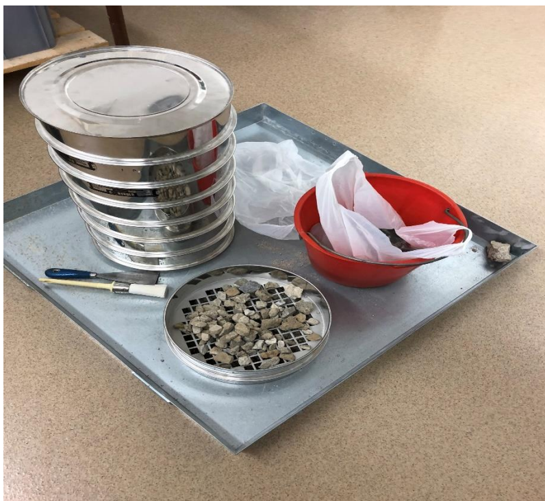
Slika 20: Priprema materijala za prosijavanje
