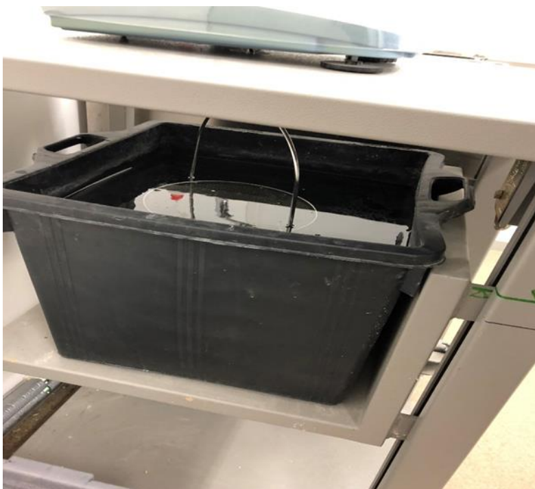
Slika 19: Vaganje materijala pod vodom
