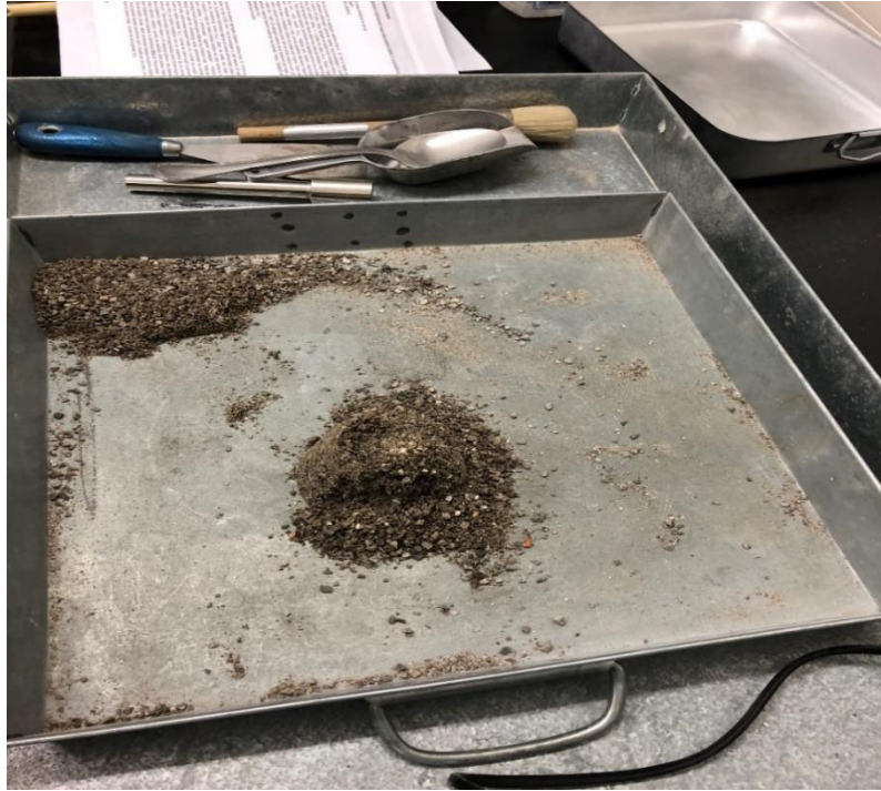
Slika 18: Uzorak nakon što je podignut kalup
