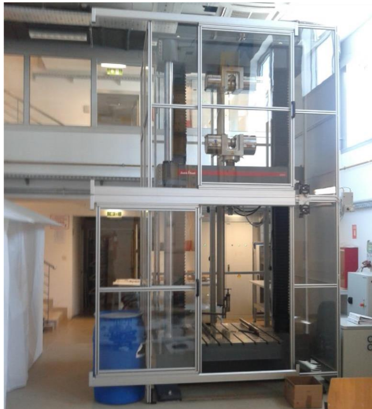
Slika 1. Univerzalni tlačno-vlačni stroj za ispitivanje (kidalica)
