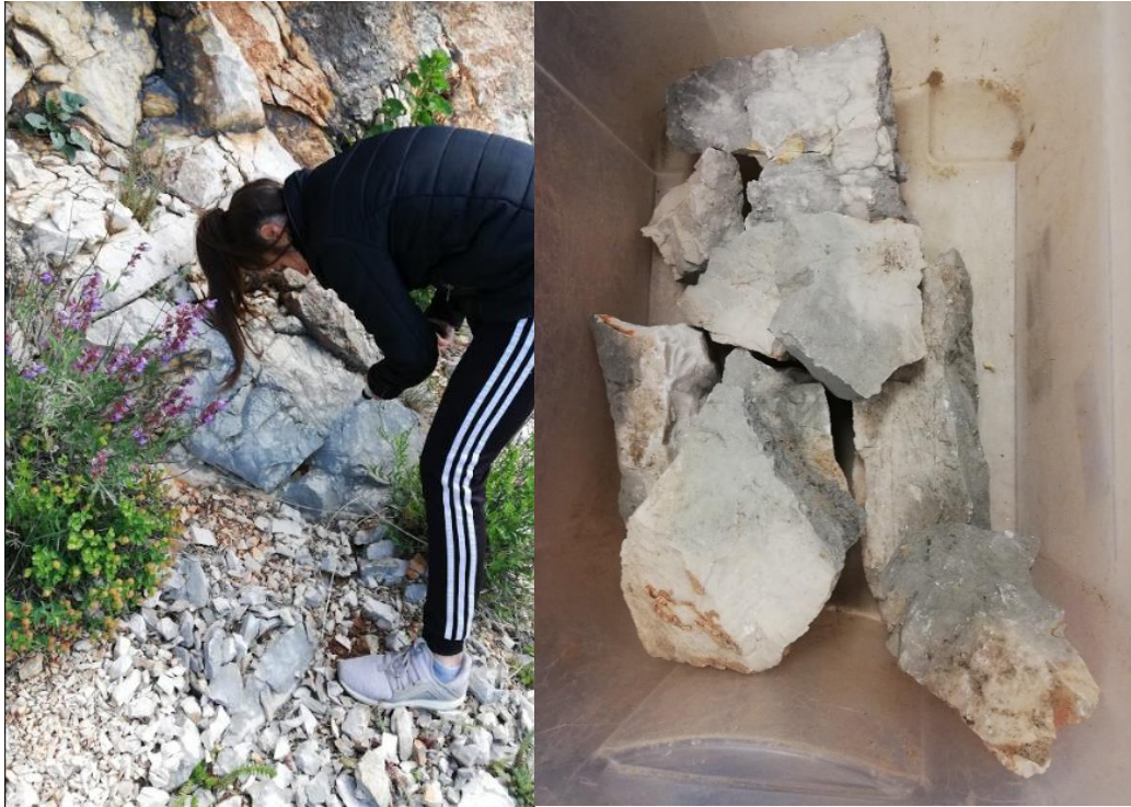
Slika 10: Vapnenci s lokacije 2: a) Munsell ljestvica boja za lokaciju 2, b) stijena na kojoj je provedeno ispitivanje Schmidtovim i geološkim čekićem na terenu, c) odlomci vapnenca korišteni u PLT ispitivanju
