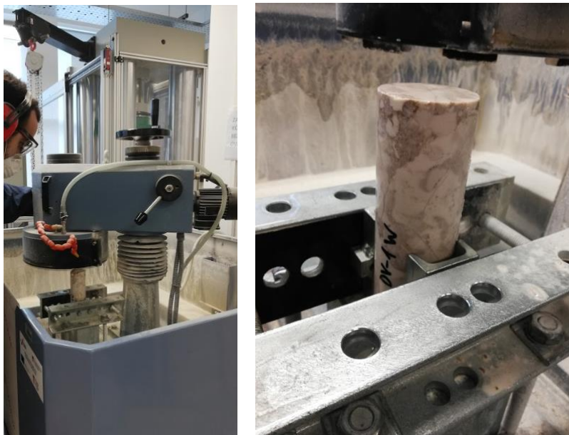
Slika 11: Priprema ispitnog uzorka u laboratoriju: a) bušenje uzorka, b) brušenje uzorka
