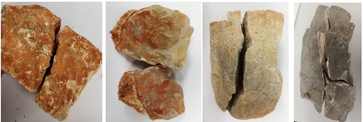
Slika 22: Odabrani uzorci nakon sloma prilikom PLT ispitivanja
