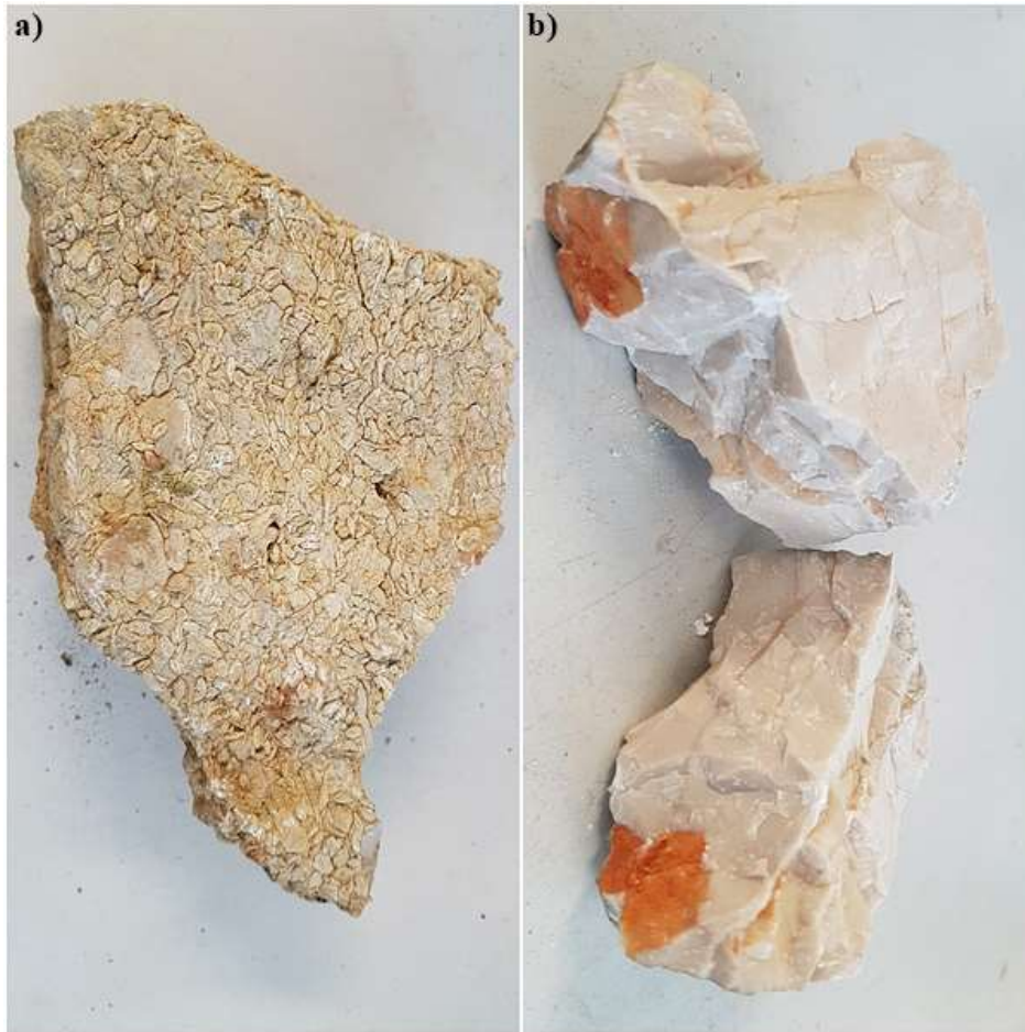
Slika 15. Uzorci ispitanih vapnenaca: a) foraminiferski vapnenaci s lokacije Vranja, pokos uz D500, u Istri; b) grebenski vapnenaci s lokacije Križišće u Vinodolskoj udolini
