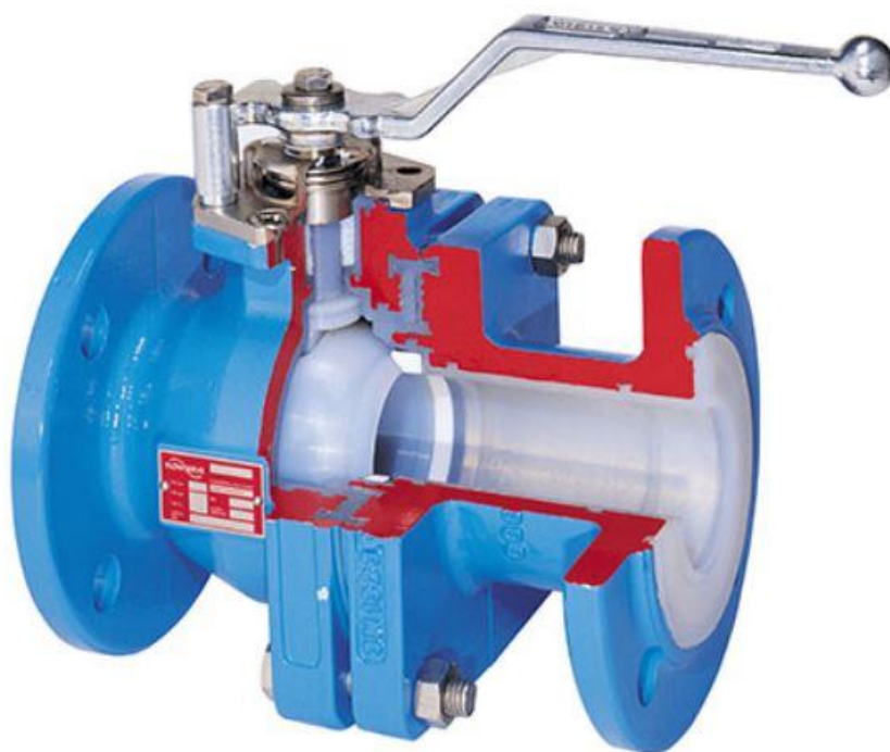
Slika 2.9. Kuglasti zatvarač sa punim provrtom [27]
