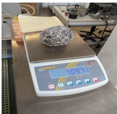
Slika 22: Vaganje uzorka nakon Cantabro ispitivanja
