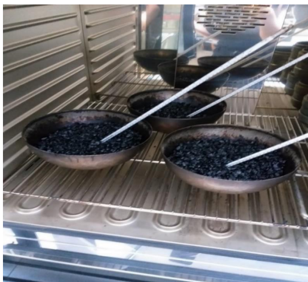
Slika 17: Pripremljena mješavina u komori za zagrijavanje
