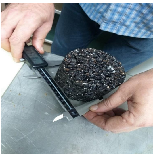
Slika 19: Mjerenje uzorka digitalnim šublerom
