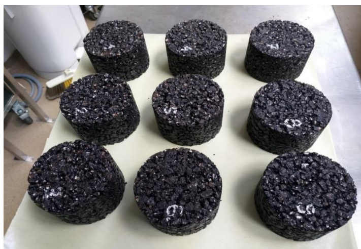
Slika 18: Uzorci od poroznog asfalta
