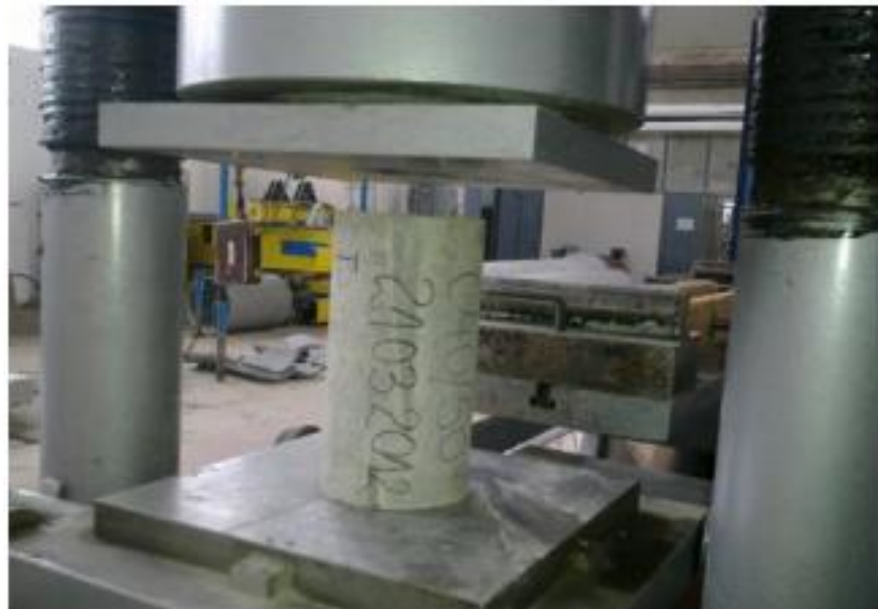
Slika 7: Ispitivanje tlačne čvrstoće na uzorku valjka
