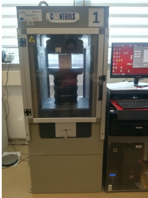
Slika 9: Uređaj kojim se nanosi tlačno opterećenje na uzorak a koristi se za ispitivanje sekantnog modula elastičnosti, Model C56Z00
