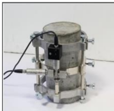
Slika 11: Model 55-c0221/E Opremljen sa dva pretvarača visoke preciznosti LDT 32 tipa.
