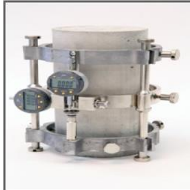
Slika 10: Model 55-C0221/D Opremljen s dva digitalna mjerača 25x0,001 mm 31
