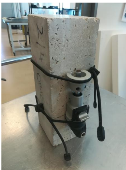
Slika 23: Ekstenziometri pričvršćeni na uzorak
