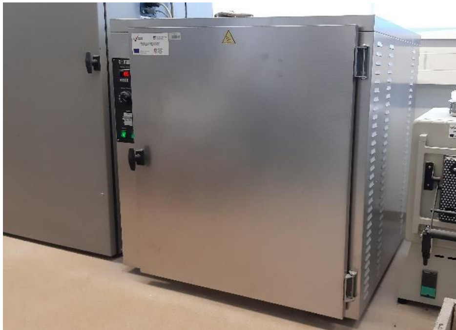
Slika 12: Sušionik za sušenje ispitivanih uzoraka.
