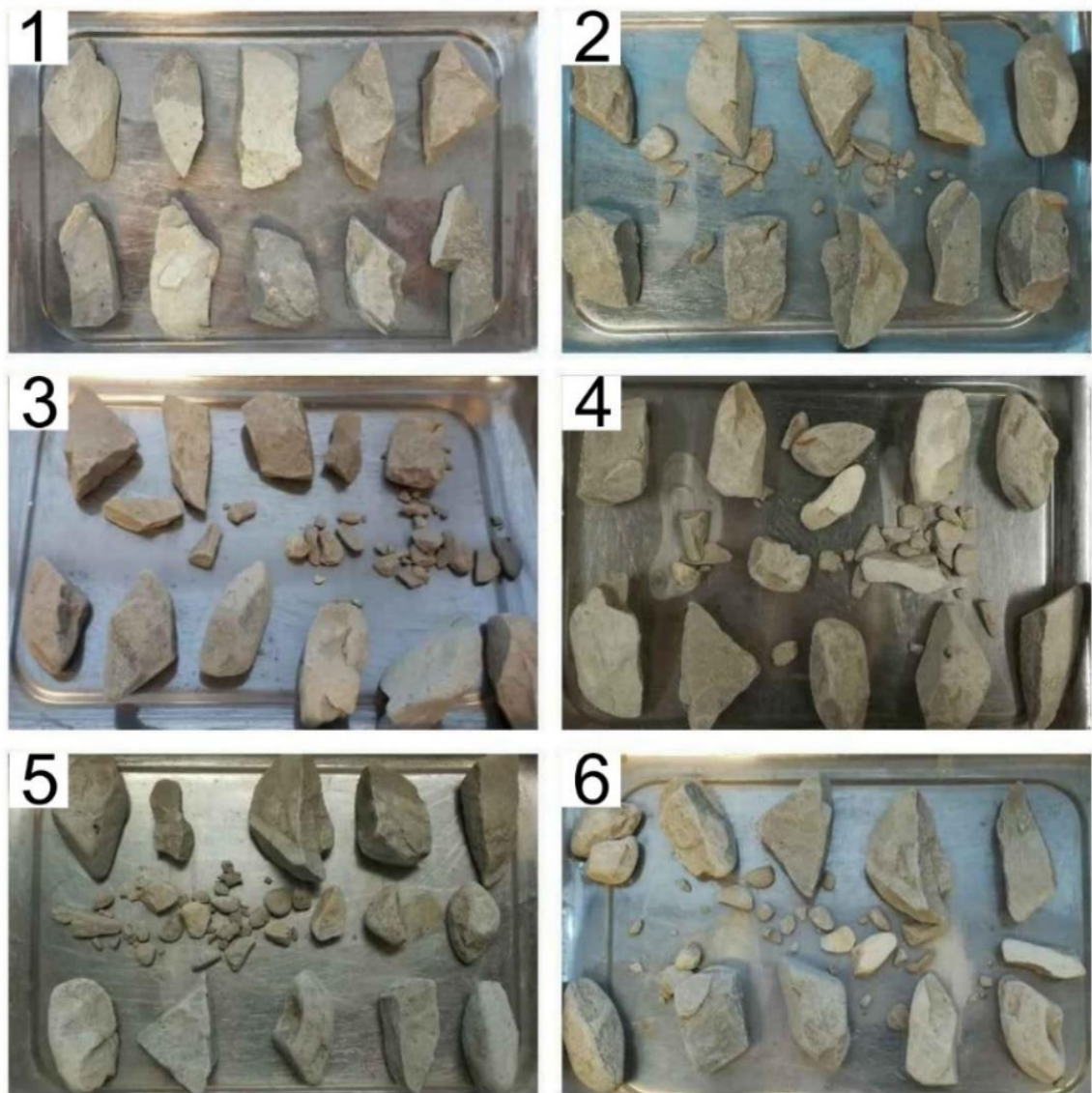
Slika 14: Prikaz uzorka nakon svakog ciklusa: br.1 uzorak prije pokusa, br.2 uzorak nakon 1.ciklusa, br.3 uzorak nakon 2.ciklusa, br.4 uzorak nakon 3.ciklusa, br.5 uzorak nakon 4.ciklusa, br.6 uzorak nakon 5.ciklusa.
