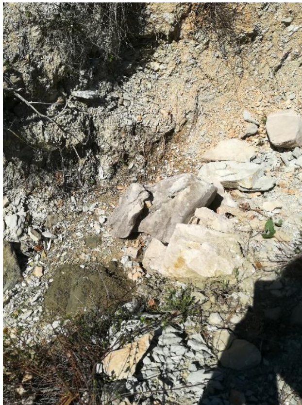
Slika 10: Lapor srednje do visoke trošnosti uzorkovan u Vinodolskoj dolini.
