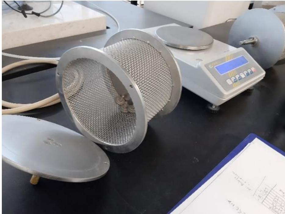
Slika 13: Čelični bubanj uređaja za ispitivanje postojanosti stijena te laboratorijska vaga korištena tijekom ispitivanja.
