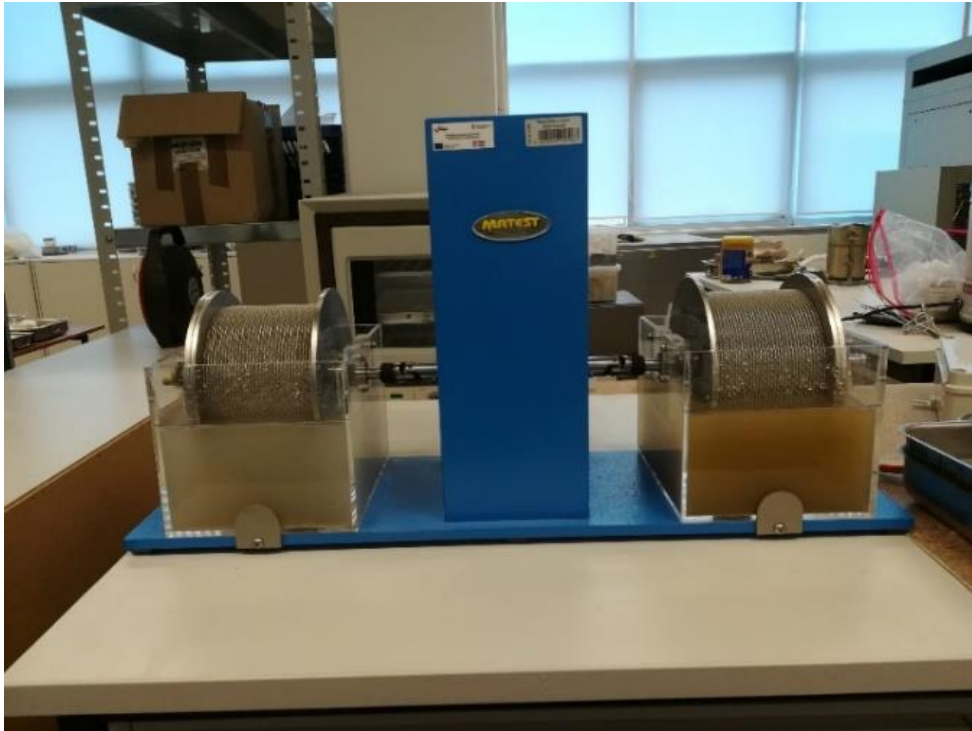
Slika 11: Uređaj za određivanje postojanosti stijene.
