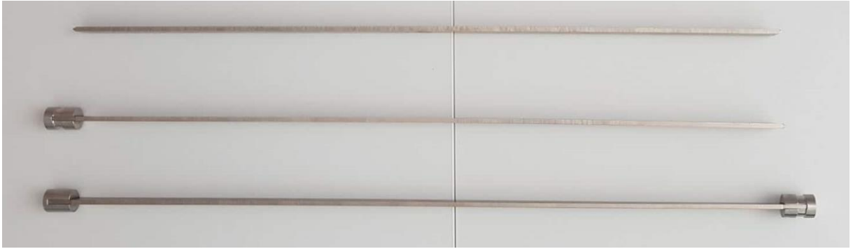
Slika 23. Uzorci za ispitivanje različitih uvjeta oslanjanja
