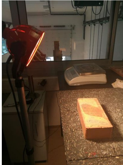
Slika 54: Uzorak opeke zagrijavan lampom [Ines Šoić]
