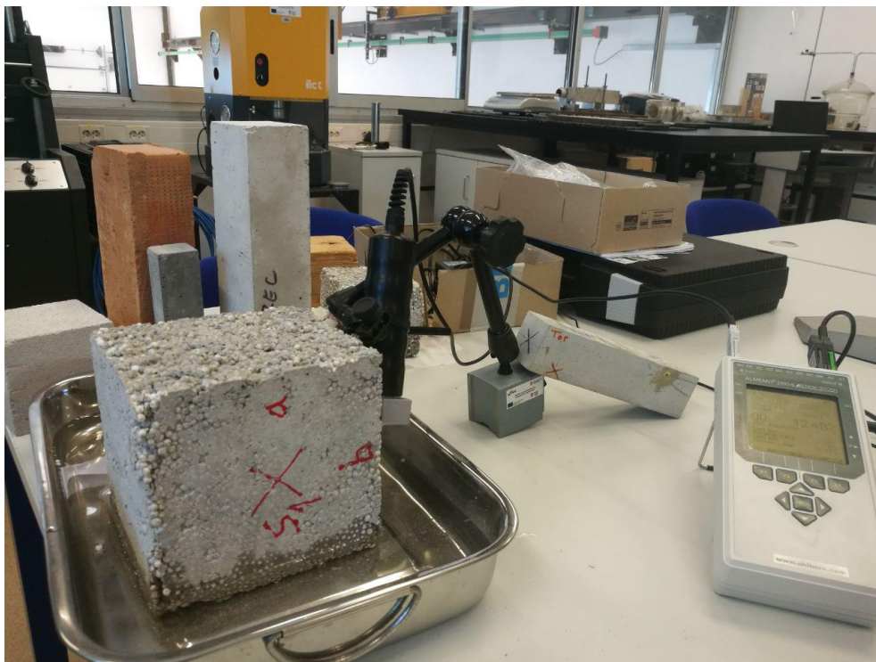
Slika 36: Mjerenje vlažnosti na uzorku stiroporbetona (uzorak 2) [Ines Šoić]
