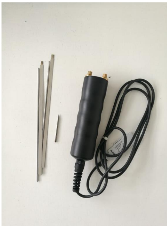
Slika 12: Sonda za vlagu drva [Ines Šoić]
