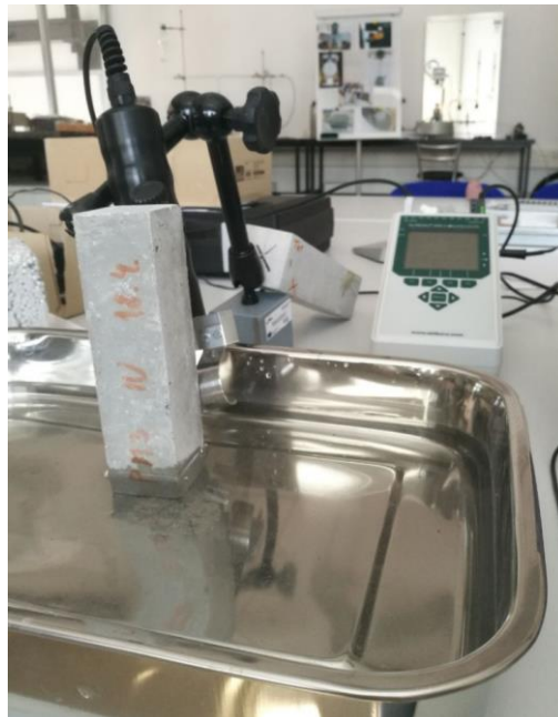
Slika 26: Mjerenje vlažnosti na uzorku cementnog morta [Ines Šoić]
