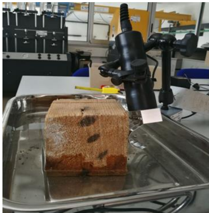
Slika 17: Mjerenje vlažnosti na uzorku drva [Ines Šoić]
