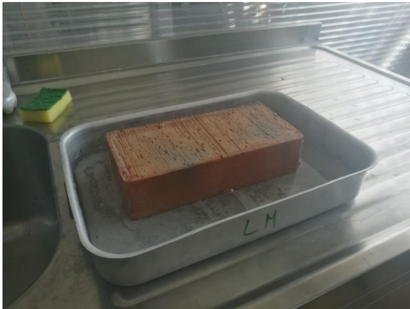
Slika 53: Uzorak opeke umočen u vodu [Ines Šoić]
