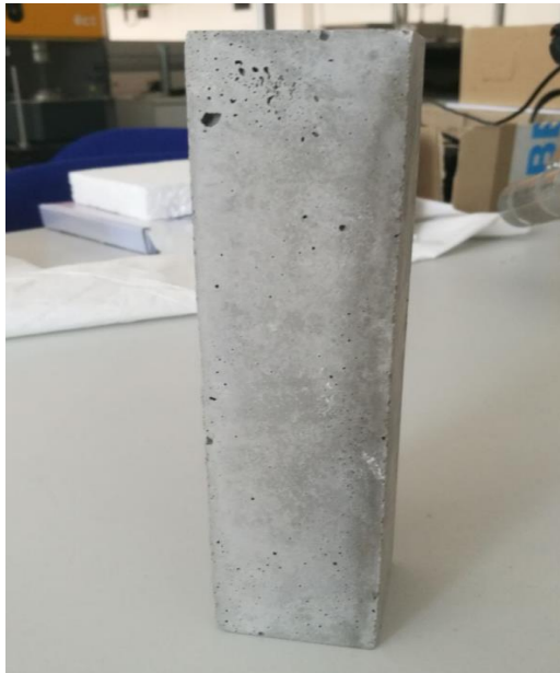
Slika 25: Uzorak cementnog morta [Ines Šoić]
