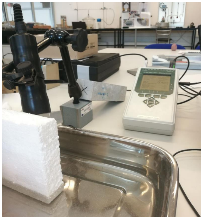
Slika 23: Mjerenje vlažnosti na uzorku stirodura [Ines Šoić]
