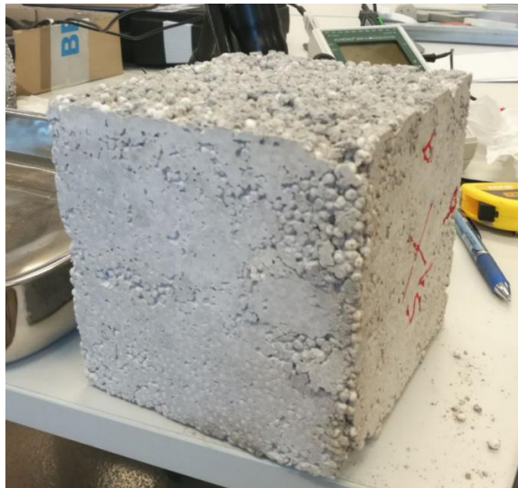
Slika 31: Uzorak stiroporbetona (uzorak 1)[Ines Šoić]
