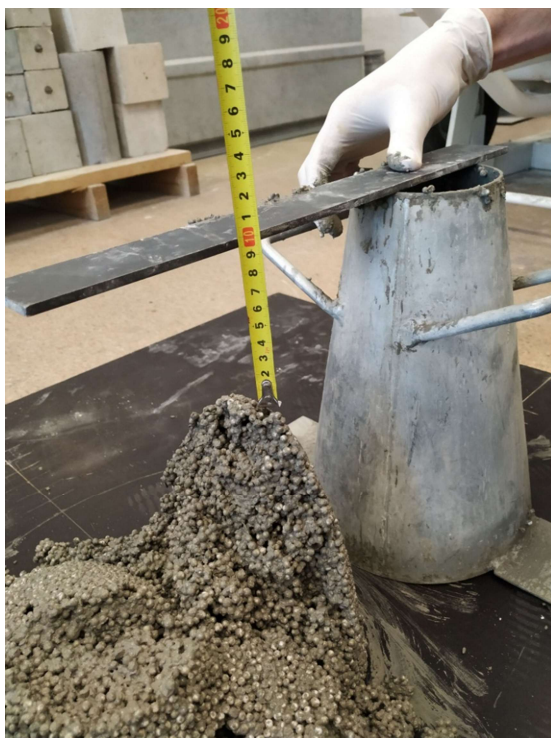
Slika 12: Prvo ispitivanje slijeganja
