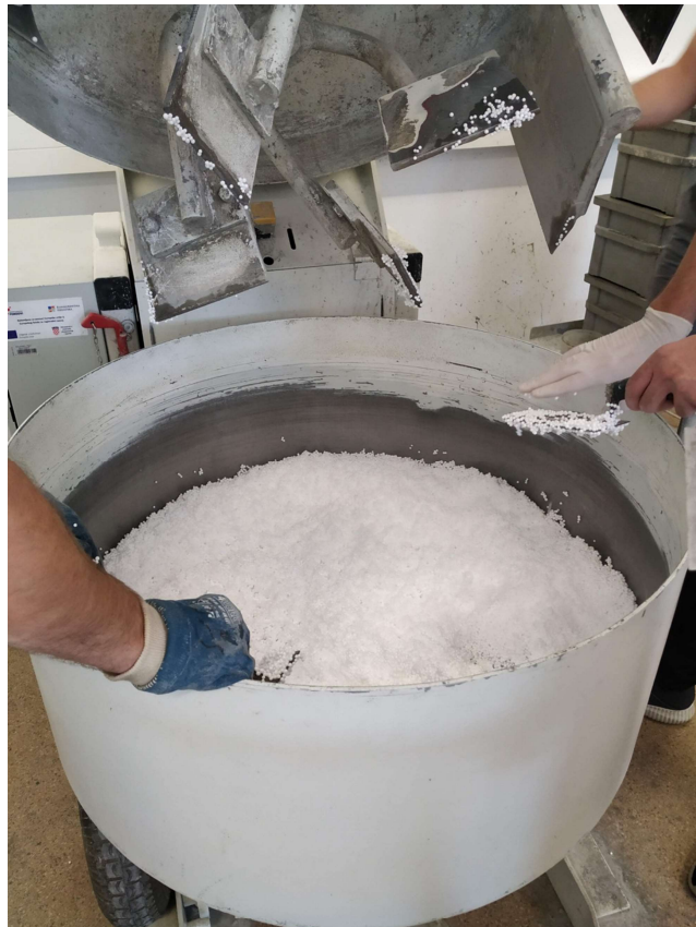
Slika 16: EPS granule pomiješane s vodom i aditivom
