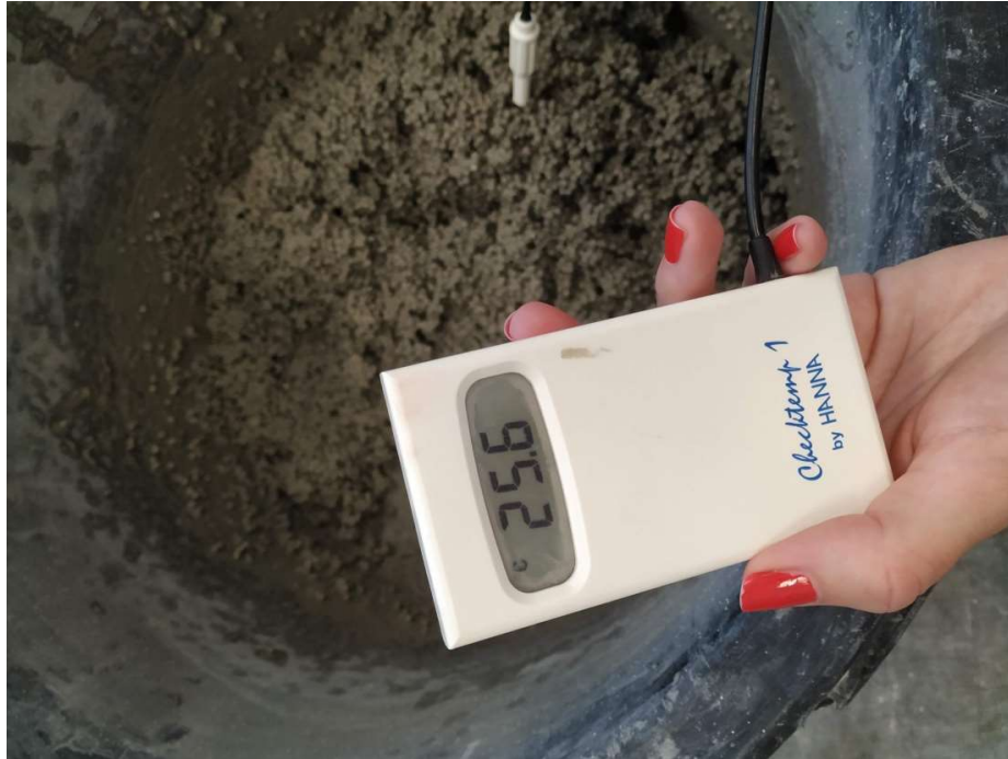
Slika 11: Mjerenje temperature smjese probne mješavine
