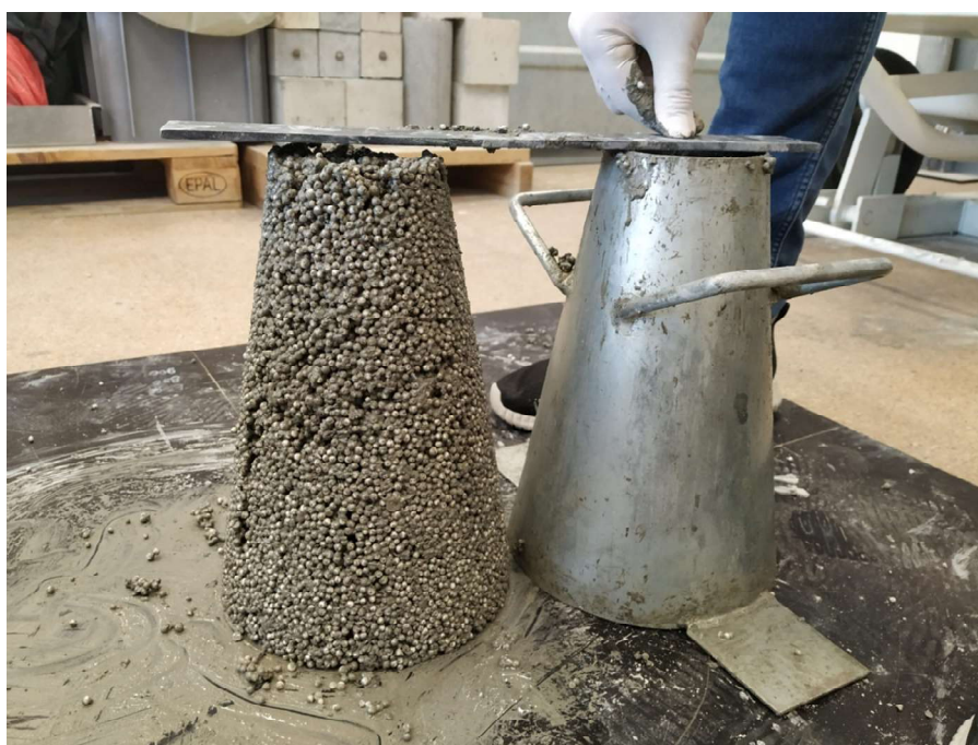
Slika 13: Drugo ispitivanje slijeganja
