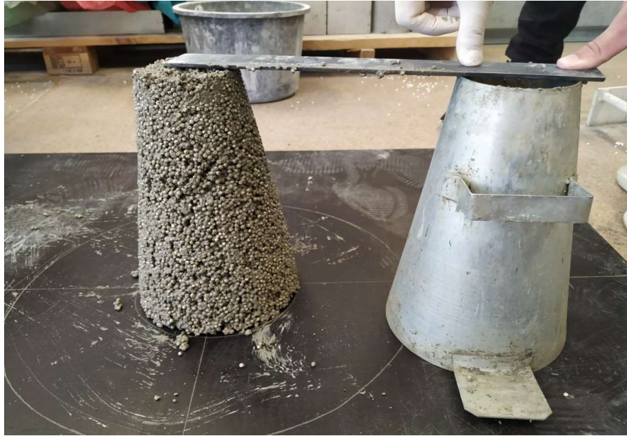
Slika 20: Ispitivanje slijeganjem druge probne mješavine
