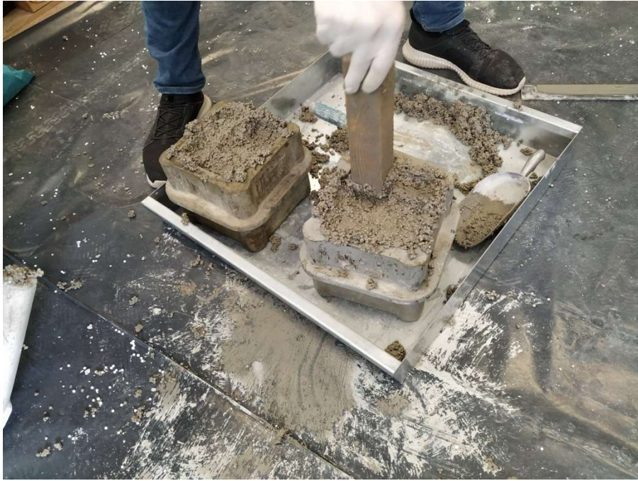
Slika 24: Kompaktiranje uzoraka drvenim batom
