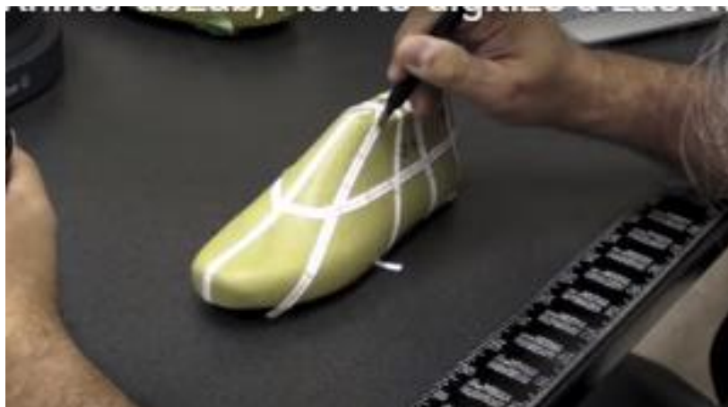
Slika 3. Prikaz skeniranja kontaktnom sondom
