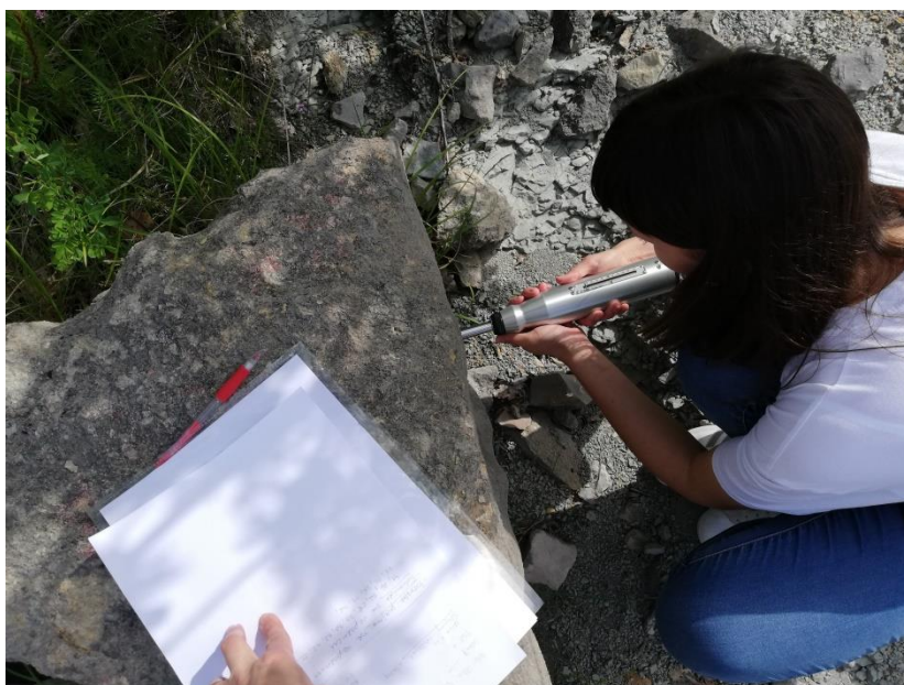
Slika 18. Ispitivanje jednoosne tlačne čvrstoće Schmidtovim čekićem na području Vele Učke.
