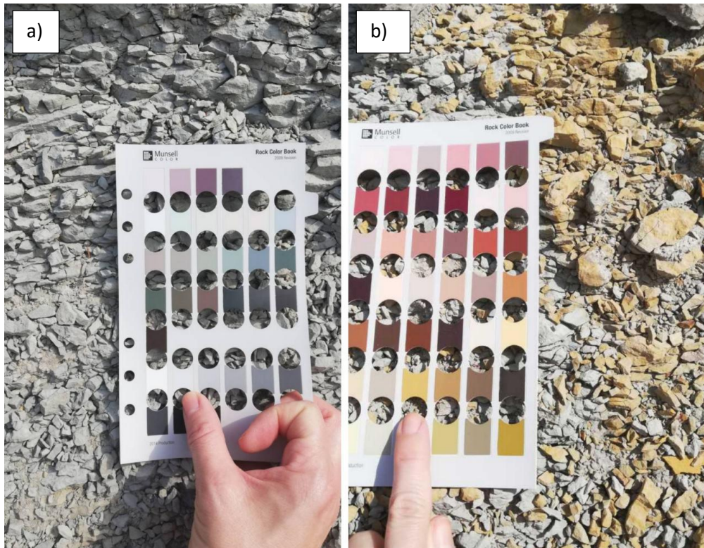
Slika 21. Boja siltita na području Vele Učke prema Munsell sustavu identifikacije; a) Siltit 1, b) Siltit 2
