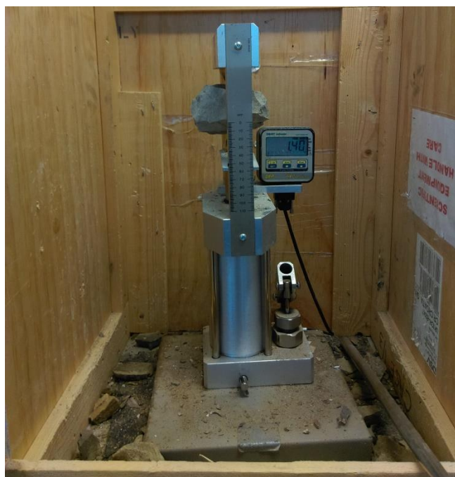
Slika 14. Uređaj za ispitivanje tlačne čvrstoće u točki.
