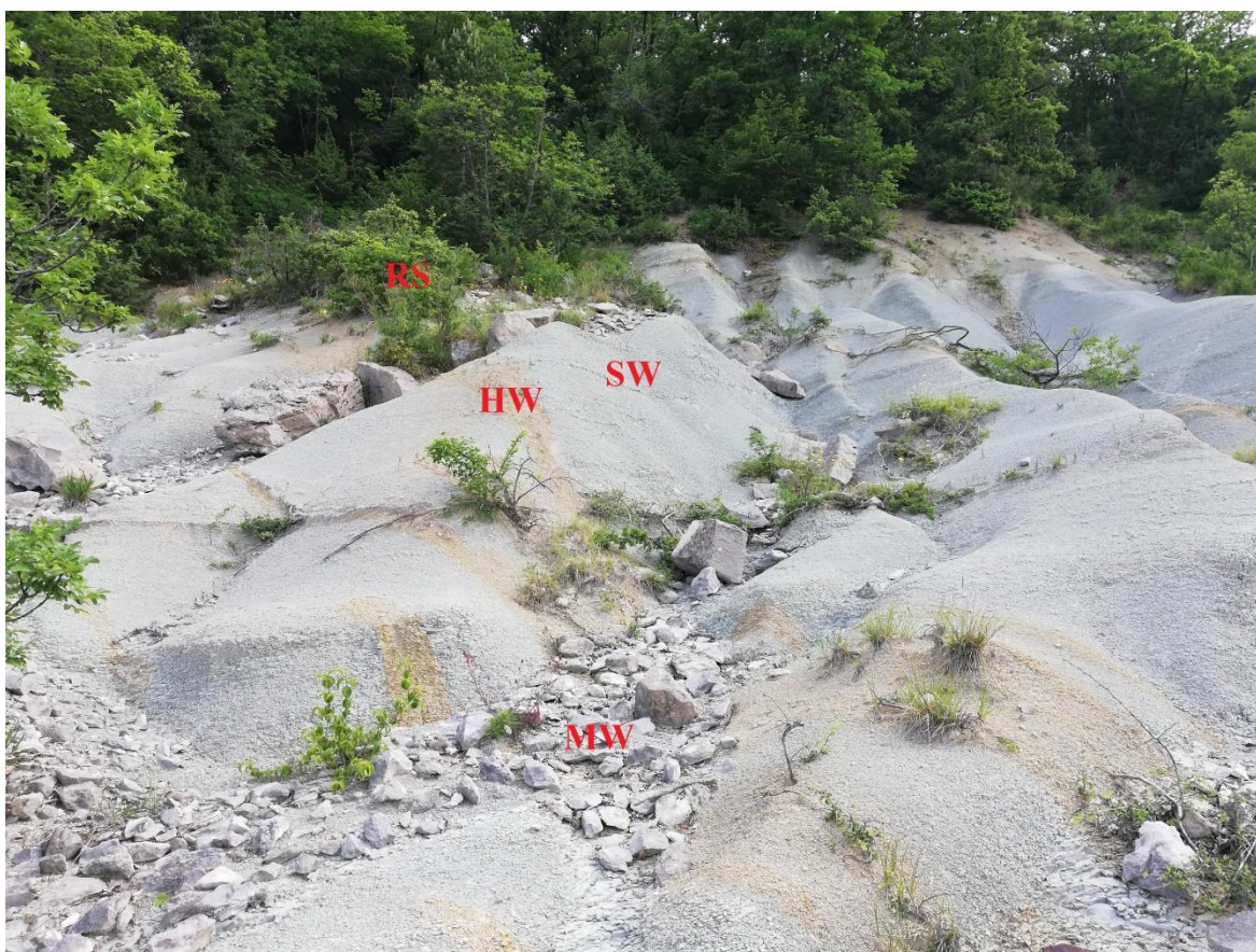
Slika 23. Stupnjevi trošnosti prema ISRM (1981) na području Vele Učke.
