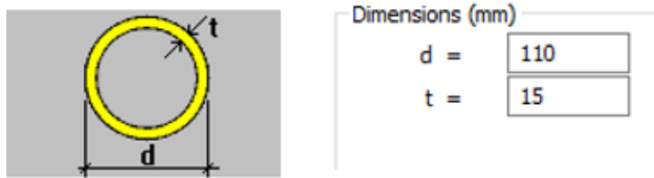
Slika 46: Izgled poprečnog presjeka izvedenog od čelika
