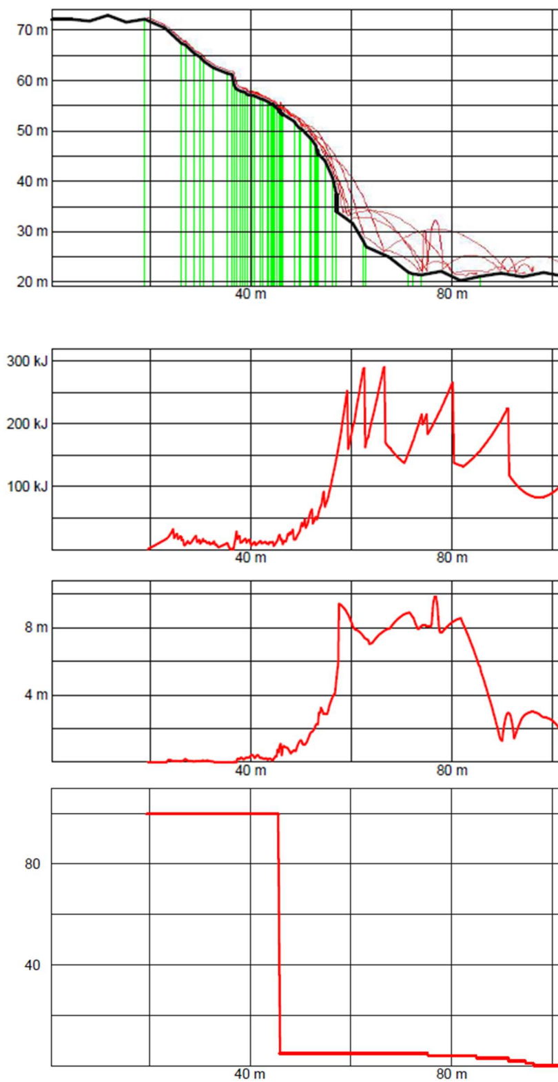
Slika 47: Trajektorija, energija udara blokova, visina odskoka te količina blokova koji su zaustavljeni na određenoj duljini
