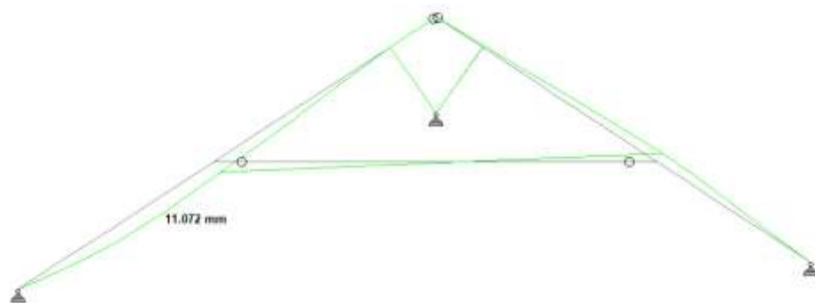
Slika 43: prikaz najvećeg konačnog pomaka POZ 102-2
