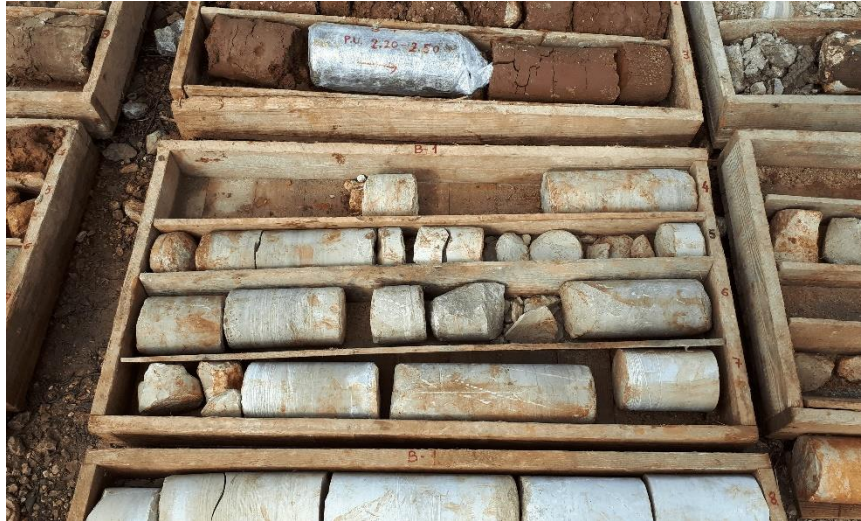
Slika 25 Primjer fotografije jezgre iz bušotina (Geotech d.o.o., 2020)
